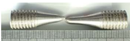
图 6 拉伸件宏观断裂形貌
