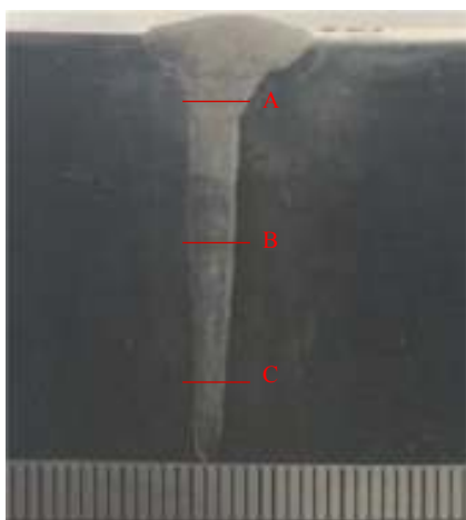
图 1 接头横截面宏观形貌
